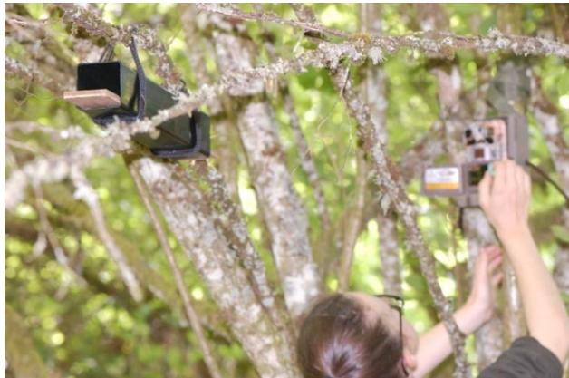
Couplage sur le terrain d'un appareil photo automatique et d'un tunnel à empreintes
